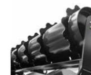
**2 Гидравлический опорный ролик** со скребком, что обеспечивает работоспособность ролика также и на влажных почвах
